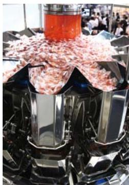
IP67の防水性能を持つデータウェイオメガ™シリーズの外見的特長の一つである多角形ホッパーは、計量業界では初めて拡散接合による部品接合を採用し、食の安全性に大きく寄与すると共に清掃性を高めるだけでなく剛性
