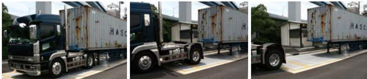
このたび、日本海事検定協会殿への納入にあたり、解決すべき問題点がありました。それは、「計量するコンテナトレーラーが必ずしも計量器の真ん中には載らない」という点です。計量所のレイアウトの関係でコンテナトレーラーは大きく左折しながらトラックスケールに進入してくるため、計量器上で車輛が進行方向に対して右もしくは左に片寄ってしまい、これをそのまま計量しますと特に輪重・偏荷重の計測に大きく影響してしまいます。(積み荷が真ん中に載っていても車輛が左に偏れば左が、右に片寄れば右が重くなる)
