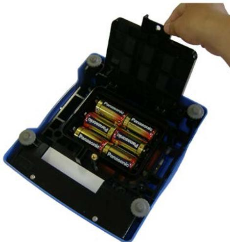
写真2 電池蓋の開け方(2)
