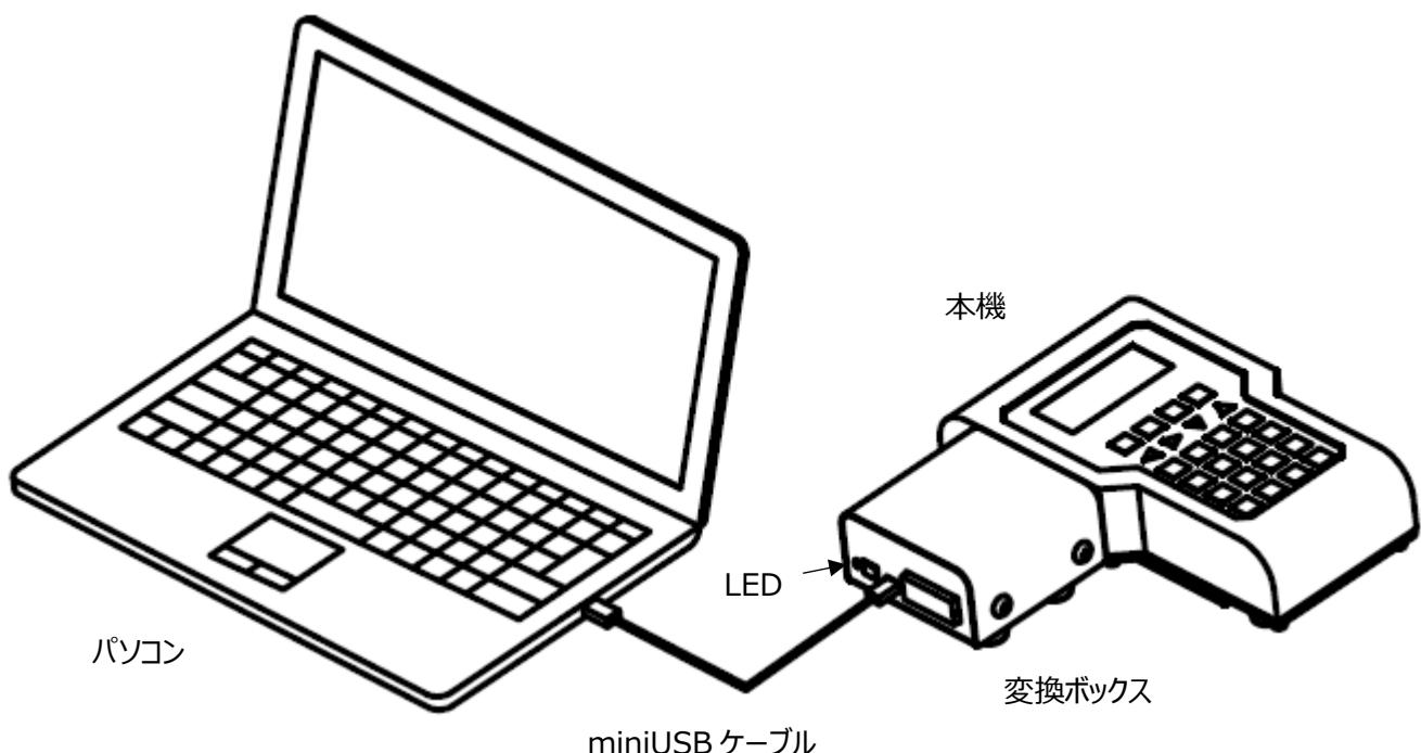
※変換ボックスの LED は電源が入ると点灯します。
