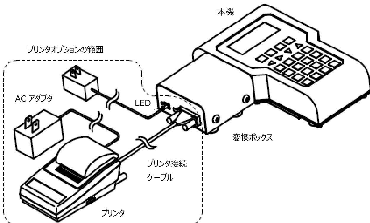
※変換ボックスの LED は電源が入ると点灯します。
