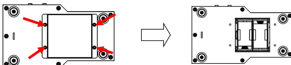
2. 電池の交換後、六角レンチを使用し 4 箇所のネジで①～④の順で電池蓋をしっかりと取り付けます。
