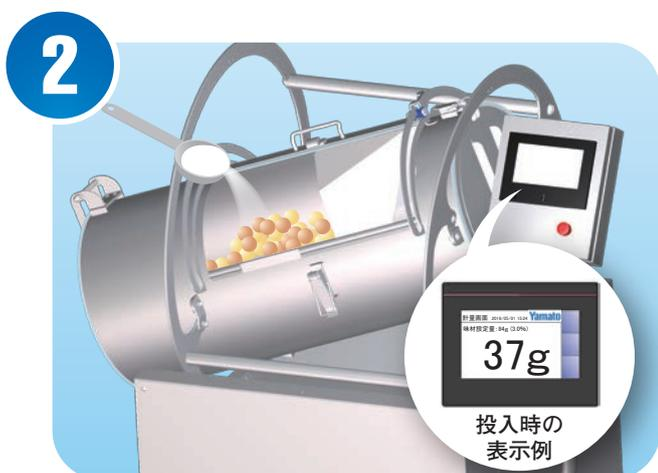
半製品が計量され、タッチパネルに適切な味材投入量（設定）が表示されます。
