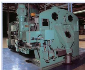
給炭計重機(コールフィーダー)は压力容器に収納され火力発電所における微粉炭の連続供給に使用されています。
