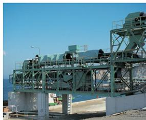
ベルトコンベヤスケールは鉄鋼プラントなどでの原料の供給・分配・積込み、荷揚げを行う際に使用されています。
