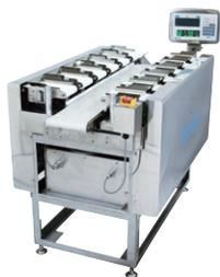
計量コンベヤに被計量物を置くだけで目標値にもっとも近くなる組合せを瞬時に見つけ、ベルトコンベヤで排出します。
