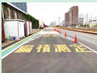
▲ 測定レーンを通り、偏積(荷物の偏り)がないかを確認します。
