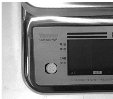
気泡の位置より、水平を確認できます。
