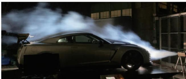
風洞システムとは、自動車の耐久性や安全性を高めるために、人工的に空気の流れを発生させ、自動車に働く力やその周りの風の流れを測定するための装置です。これまで風洞試験設備は巨大な敷地を必要とし、消費電力が多く費用も高価なため、一部の大手自動車メーカーしか導入することができませんでした。
