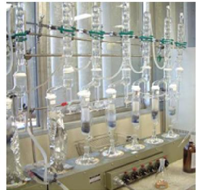
比重法は、魚の空中の重さと水中の重さを差し引いた値で割ることで比重を計算し、この比重より脂肪分を導く方法ですが、この比重法も推定式を用いて脂質含量を導くため、初段階ではソックスレー法による分析が必要となります。
