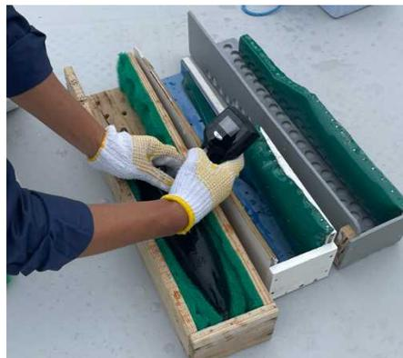
2-1 で記載したとおり、Fish Analyzer™の脂肪率は魚体温の変化に容易に反応してしまいます。長崎県総合水産試験場がブリの魚体温とインピーダンスの関係を調べたところ、魚体温が 1℃上昇するごとにインピーダンスは 100kHz で 1.45Ω、50kHz で 1.98Ω、それぞれ低下することが確認されました。これを活魚の計算式に当てはめると、魚体温が 5℃変化すると脂肪率は約 0.5%変化しており、1 目量の誤差が生じる可能性があります。活魚の基礎データを収集は、魚体温の目安となる水温 21.5±3.1℃の状況下で行いました。以上を踏まえ、**活魚は水温 20℃を目安に測定してください**。尚、活魚はアタッチメント無しで基礎データを収集していますので、測定は魚体の厚み 3cm 以上の個体で行ってください。
