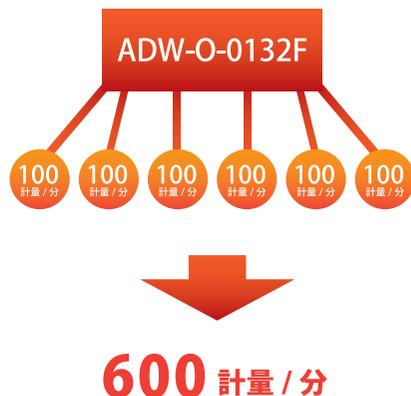
最大計量速度100計量/分×6列=600計量/分
