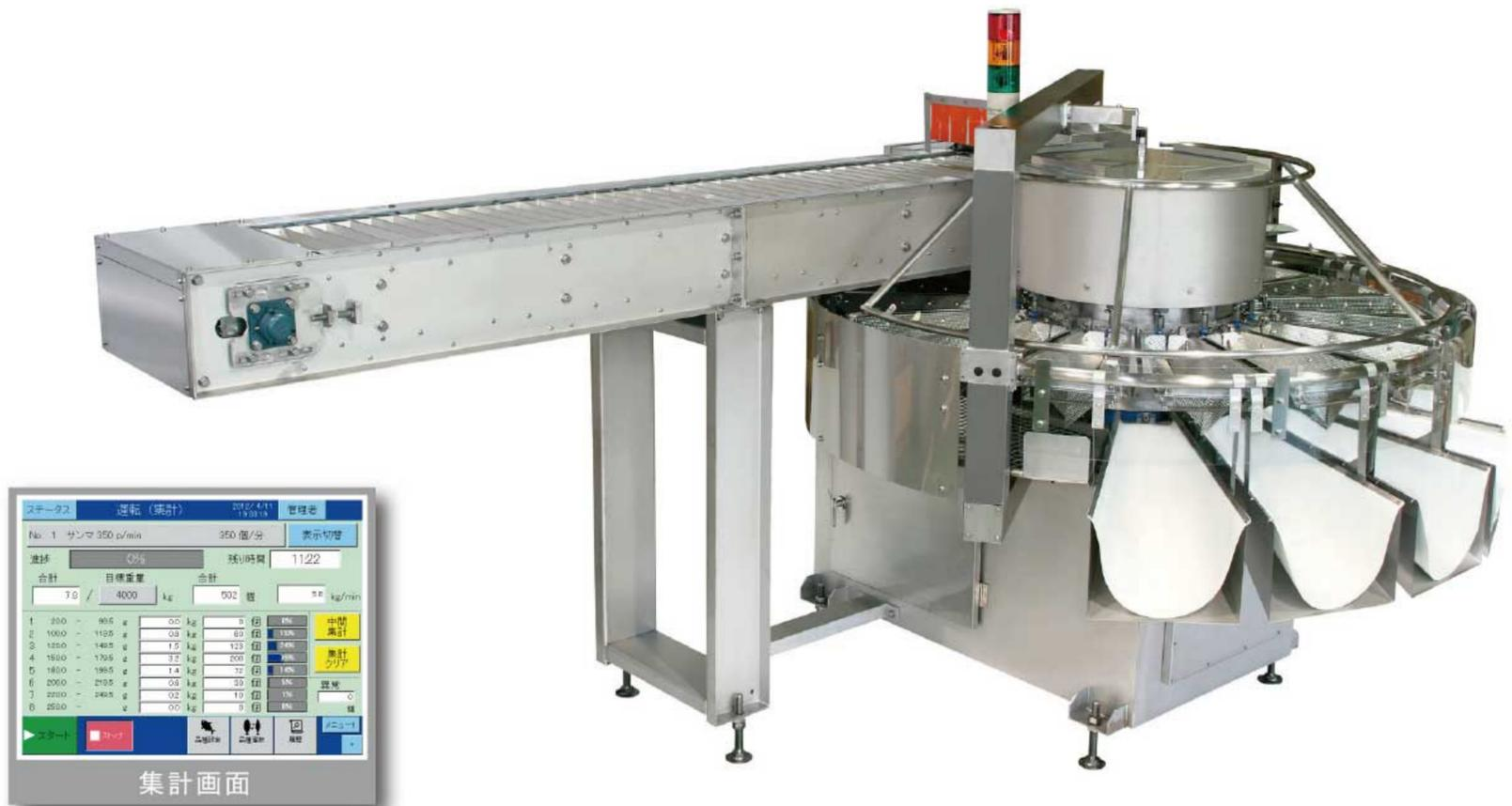
水揚げされた魚を独自の高速回転式マルチロードセル計量方式により、最大8ランクで1分間あたり最高能力さんま350匹、さば250匹を選別いたします。(従来ベルト方式の3倍速)
