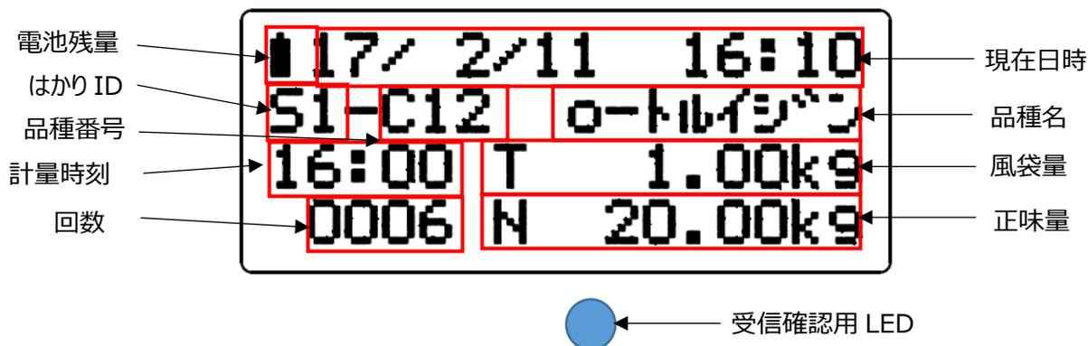
受信確認用 LED（受信時に点灯、マルチファンクション使用時は、軽量、適量、過量で色が変わる）
