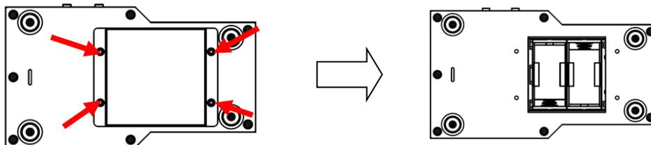
2. 電池の交換後、六角レンチを使用し 4 箇所をネジで①～④の順で電池蓋をしっかりと取り付けます。
