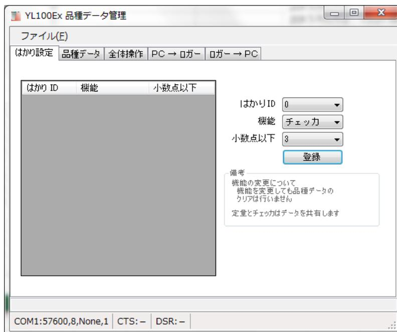
「品種データ」のタブを選択し、はかりIDを選択した後、画面右側で、品種データを設定し、最後に新規登録を押します。
