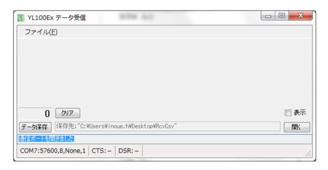
※クリアボタンは、通信エラーの発生などで、受信したパソコンのデータをクリアしたいときに押してください。 表示ボタンにチェックを入れると、通信データを表示します。 YL-100Ex 取扱説明書の"5 章のデータ出力"に従って、本機を操作して計量データを送信する。
