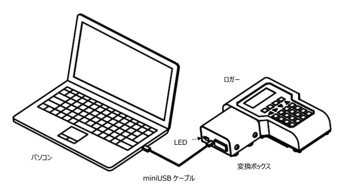
※変換ボックスにパソコンから給電されると LED が点灯します。 パソコンは危険場所に持ち込まないようにしてください。
