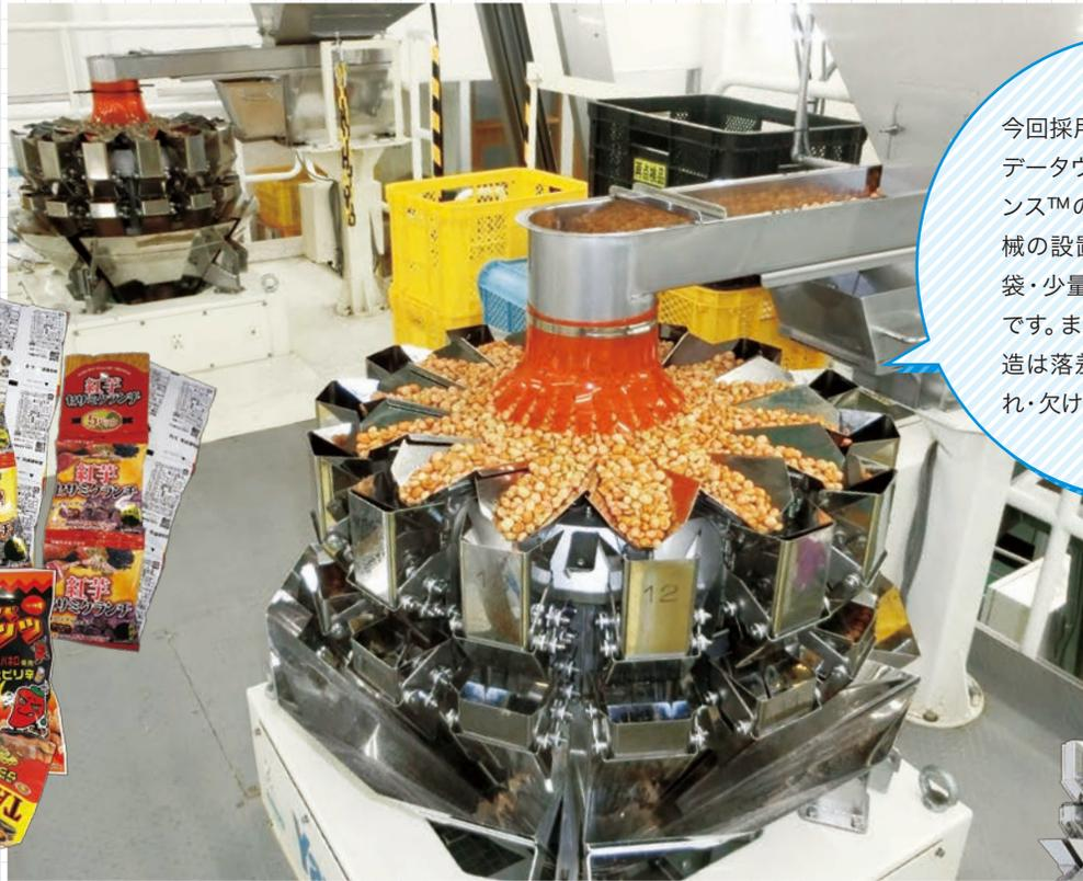
今回採用いただいた計量機はデータウェイ™アルファアドバンス™の小容量モデルで、機械の設置に場所を取らず、小袋・少量計量に最適なモデルです。またコンパクトな機械構造は落差も少なく、商品の割れ・欠け対策にも貢献します。
