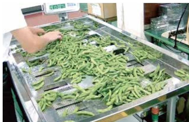
シャッターゲート仕様では、計量ユニットの商品が排出されるとシャッターゲートが開いて次の商品が自動供給されるため、作業効率の向上が可能です。
